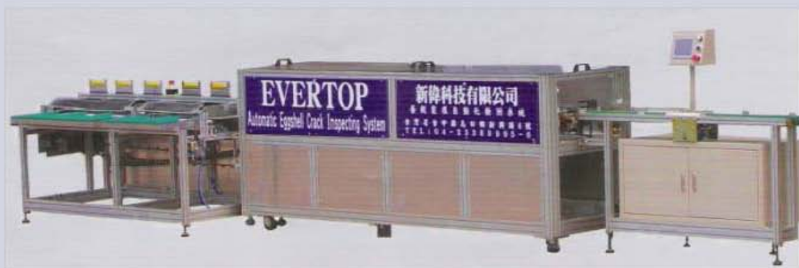
蛋殼裂痕自動化檢測系統 | 照片來源：新偉科技 | 2009
