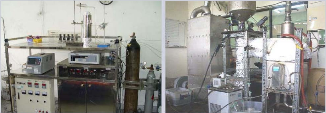
(左圖)觸媒催化反應實驗設備；(右圖)流體化床焚化爐及空氣污染控制設備
